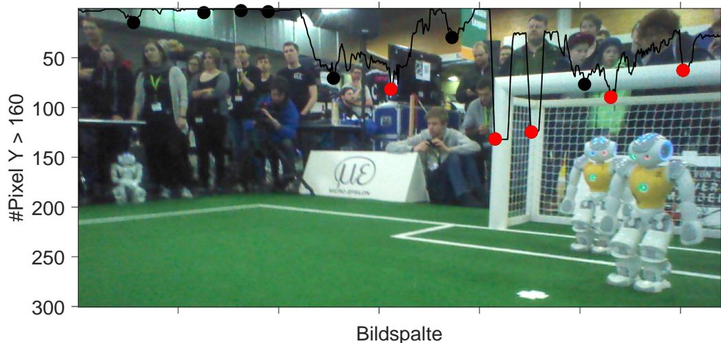
Abbildung 3.6: Spaltenhistogramm eines Bildausschnitts, German Open 2017. Alle Punkte beschreiben lokale Maxima des Histogramms, die in einer festgelegten Umgebung globale Maxima beschreiben. Nur die rot dargestellten Punkte verbleiben nach einer Filterung, die die Steigung in der Umgebung einbezieht.
