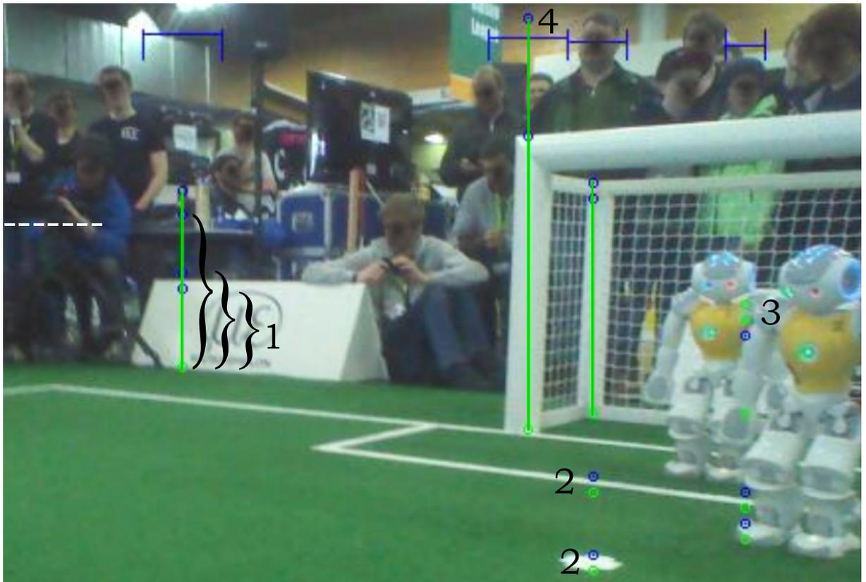
Abbildung 4.1: Lokalisierung der Pfostenkandidaten innerhalb einer Spalte. Die Nummerierung kennzeichnet Sonderfälle, die in diesem Kapitel erläutert sind. Die weiße Markierung links kennzeichnet den Horizont, die blaue Markierung am oberen Bildrand geben die zu untersuchenden Bereiche an.
