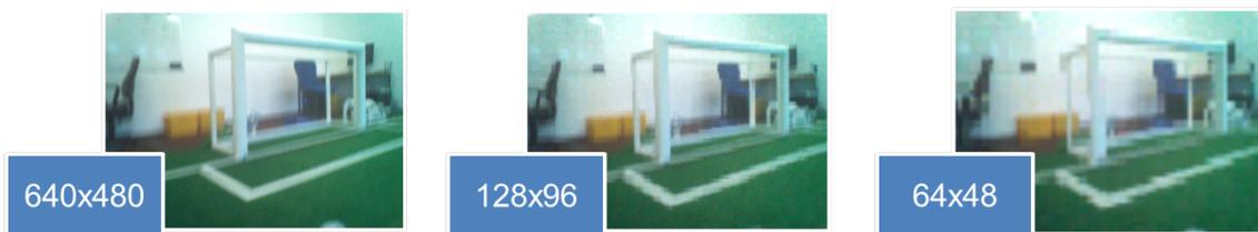
Abbildung 3.7: Bildqualität und Auflösung bei Beachtung (a) jeder (b) jeder fünften (c) jeder zehnten Spalte und Zeile
