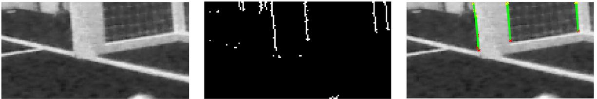
Abbildung 3.1: Originalbild (links) nach Sobel-Filterung (mitte) und Liniendetektion nach Hough (rechts)
